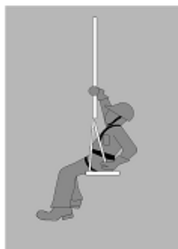
Sistema de ascenso/descenso controlado
